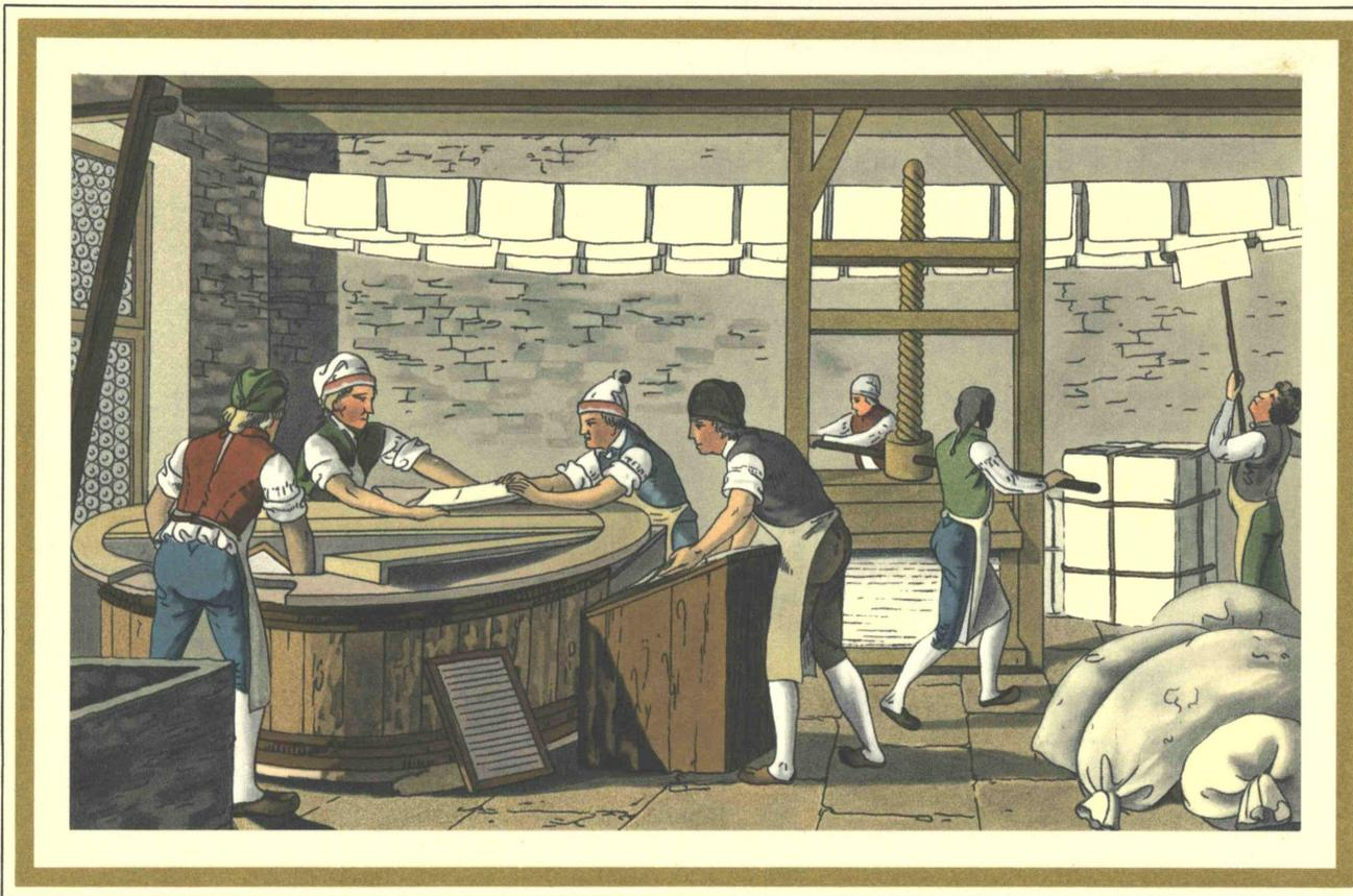
*Pendant que l'« ouvreur », à la cuve, lève la « forme », créant ainsi une feuille après l'autre, le « coucheur » s'en empare, les étend sur des feutres et les empile pour les mettre sous presse.*
